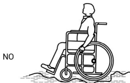
Figura 72: (Pavimento compacto y regular)
